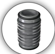
Due tenute meccaniche in carburo di silicio (SiC) chiuse all'interno di una camera olio ispezionabile per mezzo di una ghiera filettata. In questo modo le tenute meccaniche lavorano separate dai reflui ma l'accesso alla camera olio risulta estremamente semplificato e agevola le operazioni di manutenzione.
