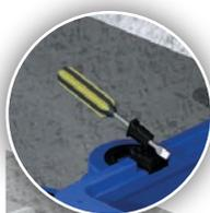
Il passaggio dei cavi elettrici avviene attraverso speciali pressacavi brevettati che consentono una perfetta tenuta. Prima di inserire il cavo, forare i pressacavi necessari con un utensile appuntito e lasciare inalterati gli altri per evitare fuoriuscite di liquido o di odori. Se la pompa è dotata di spina, praticare nel pressacavo un taglio longitudinale su un lato per consentire il passaggio del cavo senza compromettere la tenuta.
