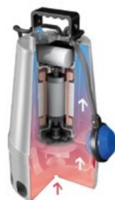
La camicia di raffreddamento garantisce la temperatura ottimale del **motore** anche quando la pompa è parzialmente immersa.
