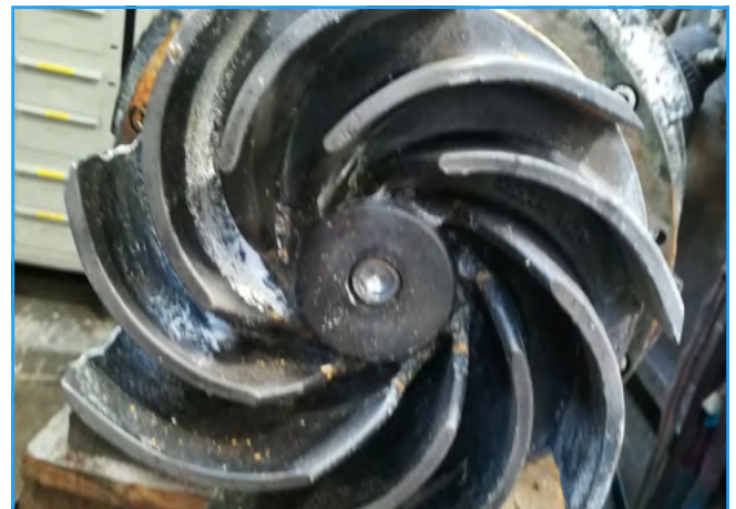
La roue vortex avec le revêtement en Molib-tech
