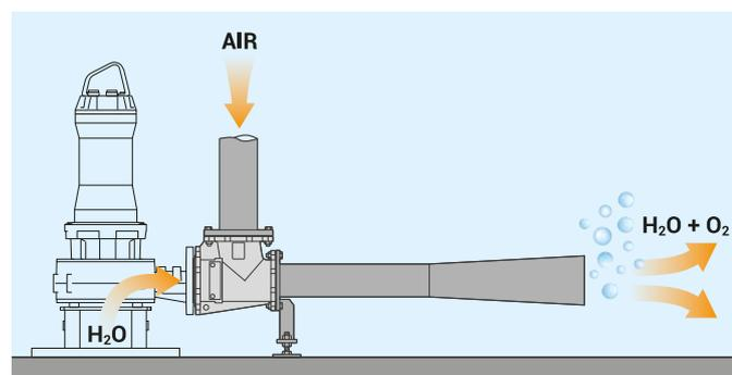
Ils sont réalisés avec des électropompes submersibles de 30 kW max. et avec des groupes hydrauliques à canaux à passage libre ample, accouplés à des éjecteurs de la série OXY.
