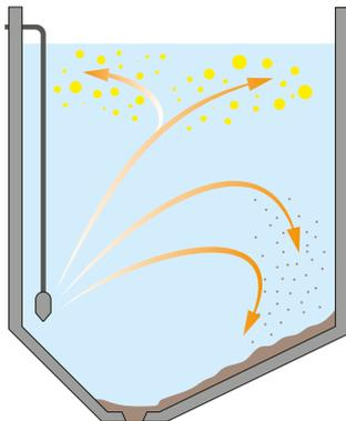
L'air injecté par le diffuseur sous forme de grosses bulles, au contact des eaux noires, induit un mouvement en spirale qui favorise la sédimentation du sable et la flottation des huiles et des graisses.
