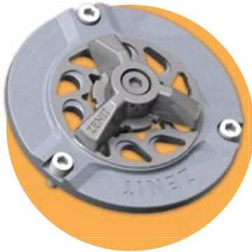
El núcleo de los modelos **GRG** es un eficaz **dispositivo de corte** con diseño completamente renovado que consta de una placa con agujeros y bordes afilados y una cuchilla triangular giratoria a ras, integrada en el rotor, ambas realizados en **acero martensítico X 102 CrMo 17 KU**.
