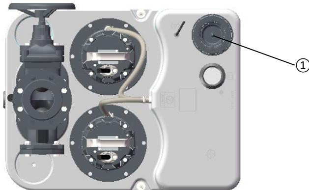
图 6.8：气压软管连接位置
