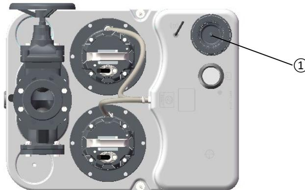
图 6.8：气压软管连接位置
