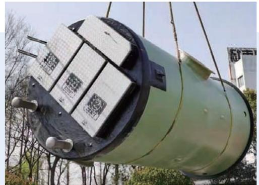
高强度玻璃钢材质筒身，缠绕工艺一次成型无泄漏。筒体耐腐蚀强度高，可满足输送生活污水及接近生活污水性质的工业废水要求。
