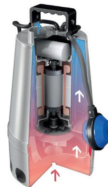
冷却套利用抽送液体进行电机冷却，水泵在部分浸没的情况仍可良好运行。
