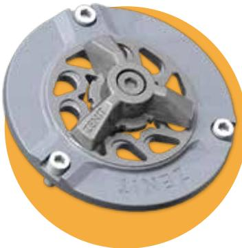
Сердце моделей **GRG** - это эффективное **измельчительное устройство**, полностью технически переработанное, состоящее из пластины с отверстиями с острыми краями и, на одном уровне с ней, треугольным вращающимся ножом, встроенным в рабочее колесо. Оба компонента выполнены из **мар滕ситной стали X 102 CrMo 17 KU**.
