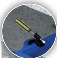
El paso de los cables eléctricos se efectúa a través de especiales prensacables patentados que garantizan perfecta estanqueidad. Antes de introducir el cable, perforar los prensacables necesarios con una herramienta puntiaguda, dejando intactos los demás para evitar pérdidas de líquido y la salida de olores. Si la bomba está dotada de enchufe, hacer un corte longitudinal en el prensacable por un lado para permitir el paso del cable sin perjudicar la estanqueidad.
