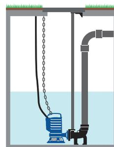
CON DISPOSITIVO DE ACOPLAMIENTO DE FONDO
