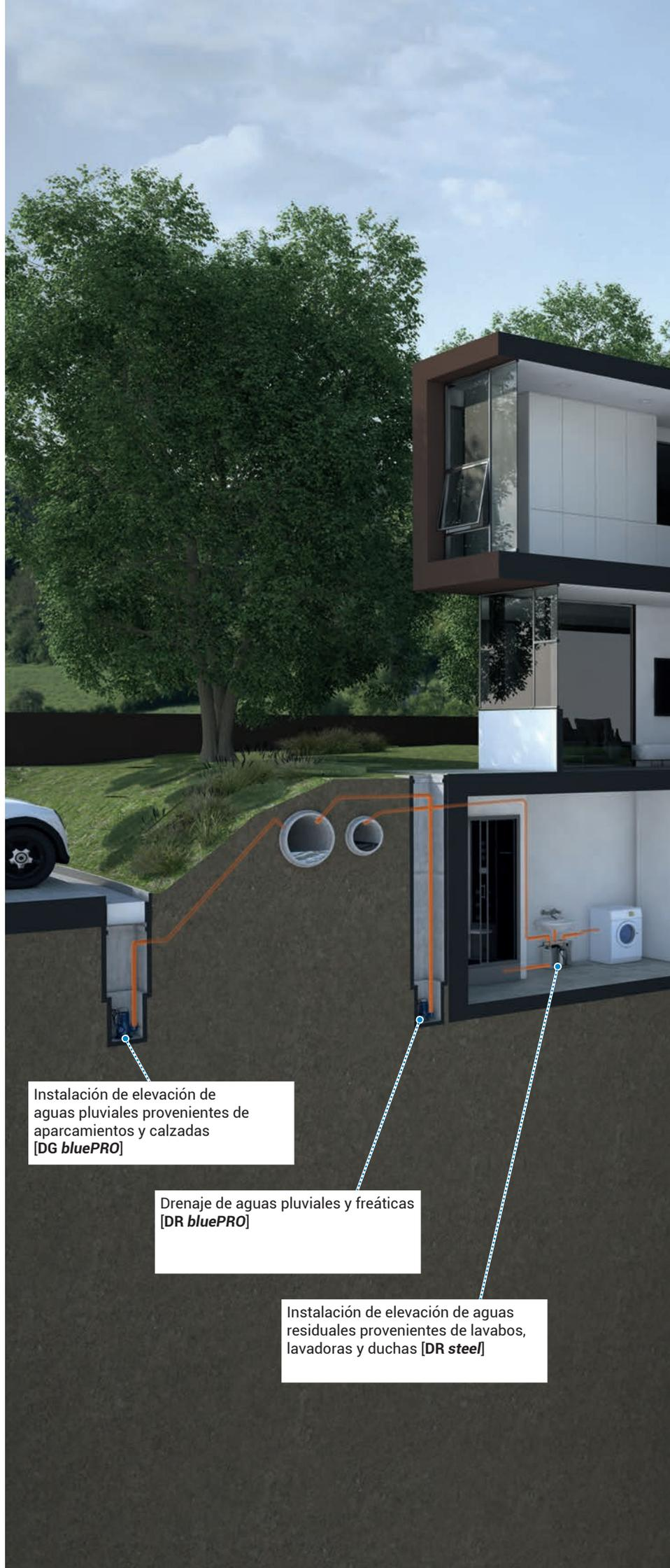
Instalación de elevación de aguas pluviales provenientes de aparcamientos y calzadas [DG bluePRO]
