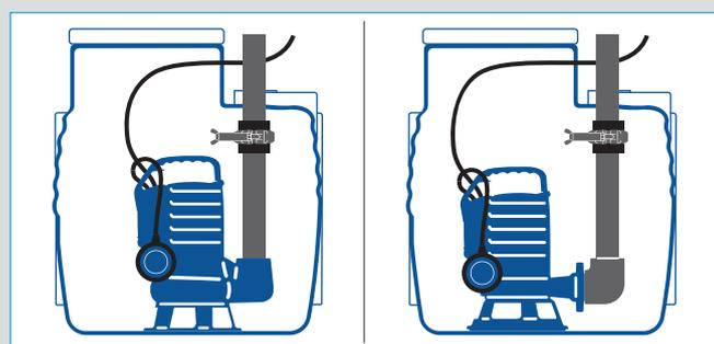
Además, es posible utilizar un flotador opcional (que se conectará con un cuadro eléctrico de control) con función de alarma de rebosamiento.
