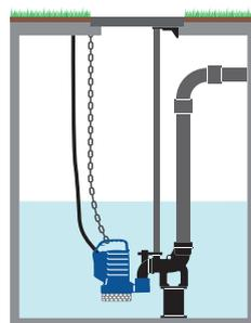
CON DISPOSITIVO DE ACOPLAMIENTO DE FONDO
